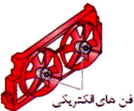
بدیهی است سیستم فن بر پروانه برتری دارد چراکه باعث افزایش راندمان موتور و کاهش مصرف سوخت می‌گردد. به عنوان مثال در شرایط آب و هوایی سرد، نیازی به خنک شدن مضاعف موتور نمی‌باشد لذا فن خاموش می‌شود و بدین وسیله در مصرف انرژی صرفه جویی می‌شود.
