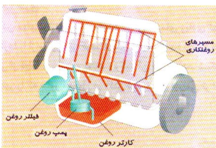
مهمنترین وظیفه روغن چرب کنندگی و روانکاری قطعات در حین کار می‌باشد. روغن کاری در عین حالی که از سائیدگی قطعات جلوگیری می‌نماید باعث خنک
